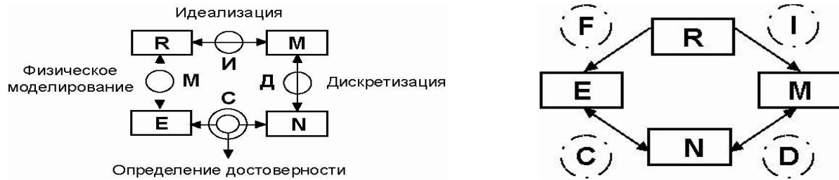
Рис.1. Общая схема соотношения этапов исследования элементов горно-шахтного оборудования: R – реальный объект; M – математическая модель; N – численная модель; E – экспериментальная модель; F – физическое моделирование; I – идеализация; D – дискретизация; C – сравнение
