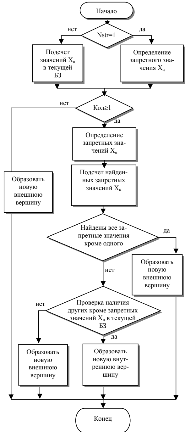
Рис. 6. Блок-схема алгоритма определения очередного действия
