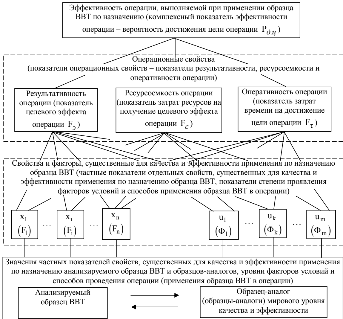
Рис. 3. Иерархическая структура задачи оценивания, сравнительного анализа и прогнозирования уровня эффективности операции, выполняемой при применении образца ВВТ по назначению
