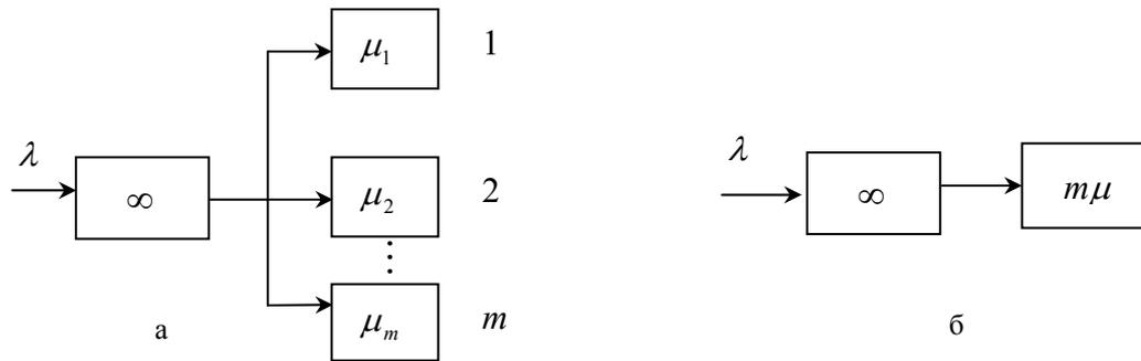
Рис. 3. Система обслуживания: а – многоканальная, б – одноканальная
