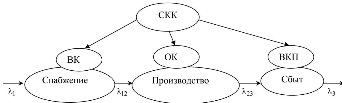
Рис. 1. Структурная схема логистического контроля качества ( $\lambda_1, \lambda_{12}, \lambda_{23}, \lambda_3$  – интенсивности материальных потоков производимой продукции)
