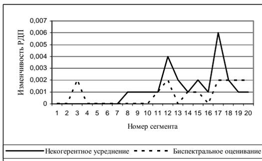
Рис. 7. Изменчивость РДП как функция порядкового номера сегмента – крылатая ракета GLCM
