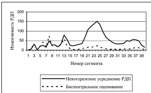
Рис. 5. Изменчивость РДП как функция порядкового номера сегмента – самолет Tu-16
