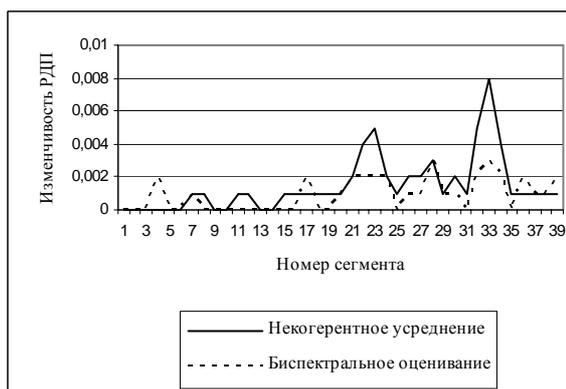
Рис. 3. Изменчивость РДП как функция порядкового номера сегмента – крылатая ракета GLCM
