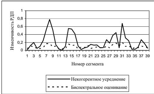
Рис. 4. Изменчивость РДП как функция порядкового номера сегмента – самолет MiG-21
