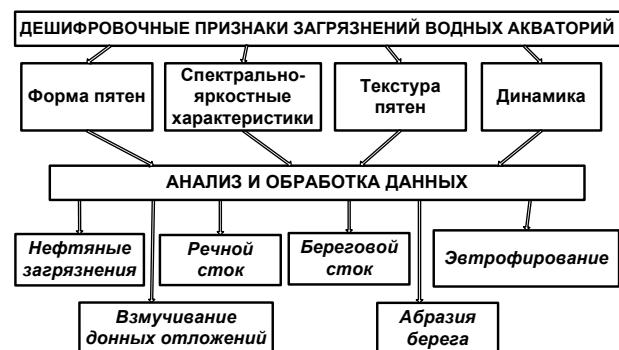
Рис. 1. Схема идентификации типа загрязнений по дешифровочным признакам
