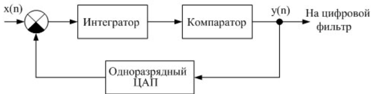
Рис. 2. Структурная схема сигма-дельта модулятора первого порядка
