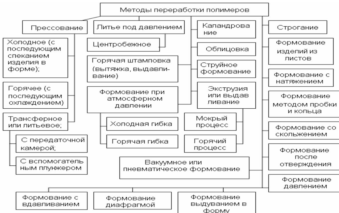
Рис. 1. Классификация методов формообразования деталей из термопластов
