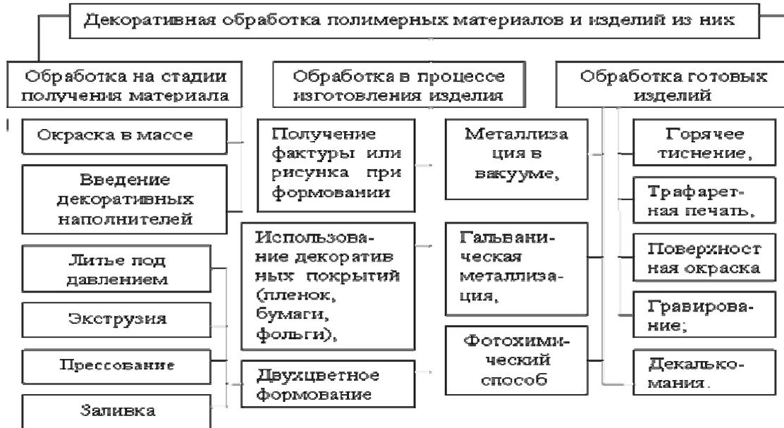
Рис. 2. Декоративная обработка полимерных материалов
