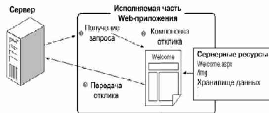
Рис. 3. Web-приложение генерирует отклик из серверных ресурсов
