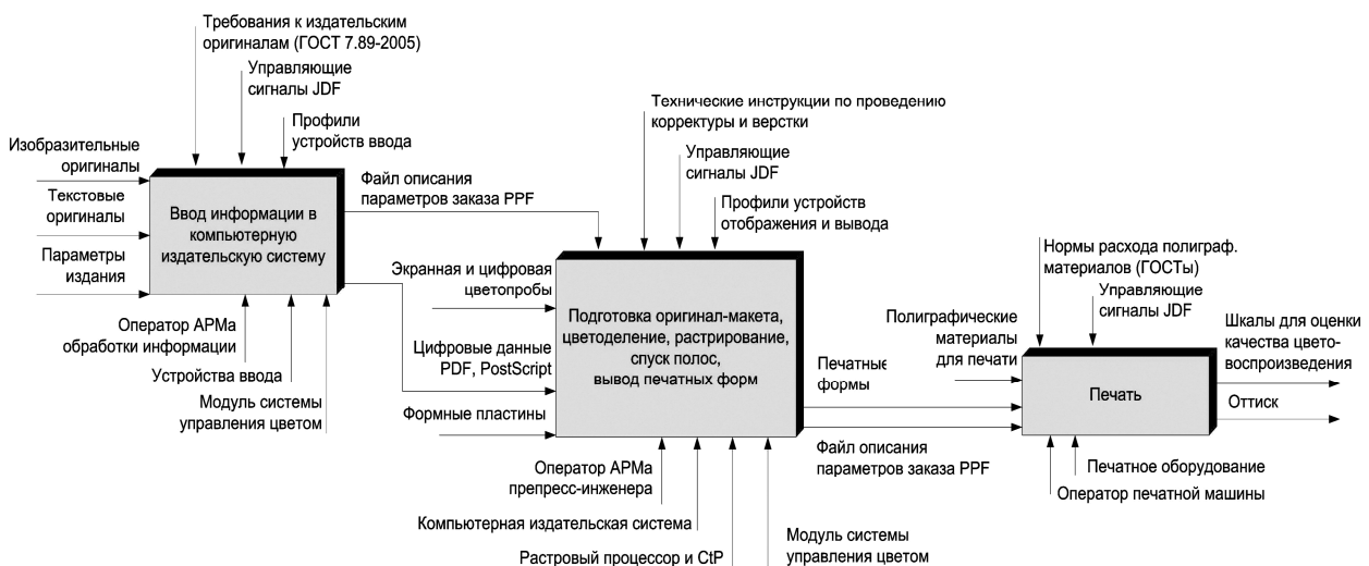
Рис. 1. Функциональная модель IDEF0 процесса изготовления печатной продукции, где представлены логические отношения между работами
