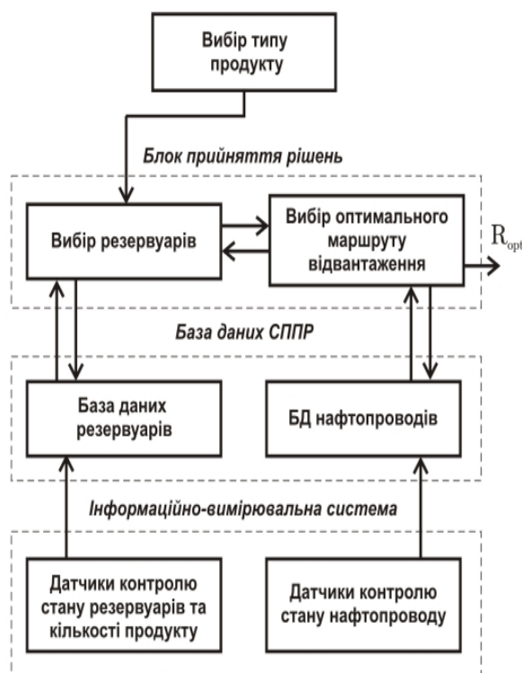
Рис. 1. Структурна схема СППР для оптимізації рідинних вантажопотоків
