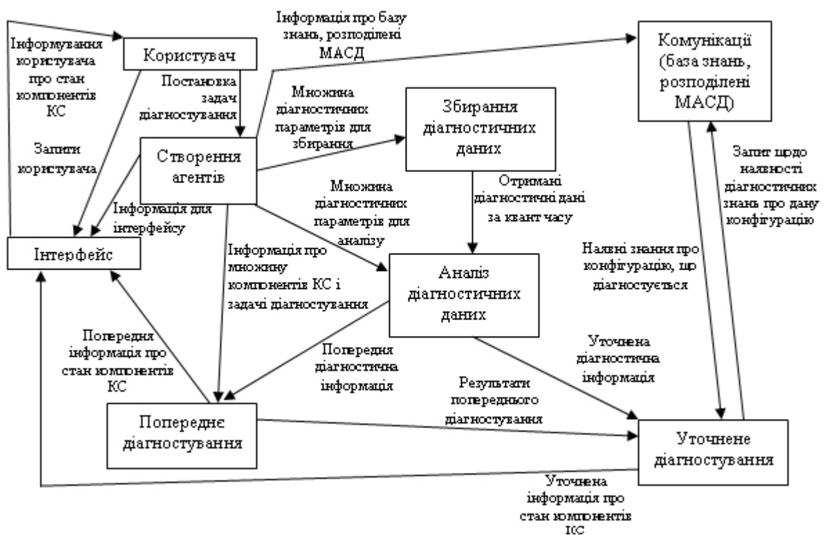
Рис. 1. Граф інформаційних потоків процесу діагностування
