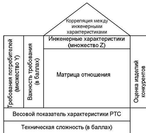
Рис. 2. Матрица метода QFD, определяющая функцию  $\delta$
