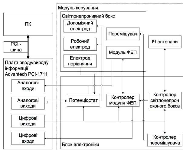
Рис. 1. Структурна схема ЕХЛ-аналізатору ЕЛАН-3d
