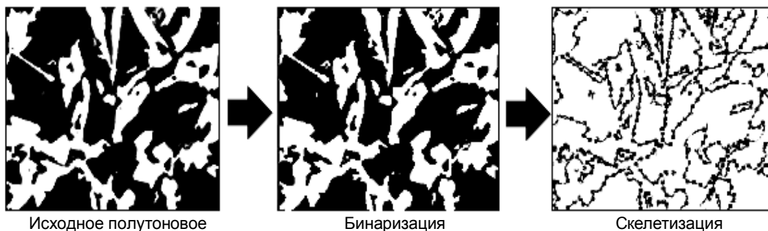
Рис. 1. Результат предварительной обработки изображения микроструктуры металла
