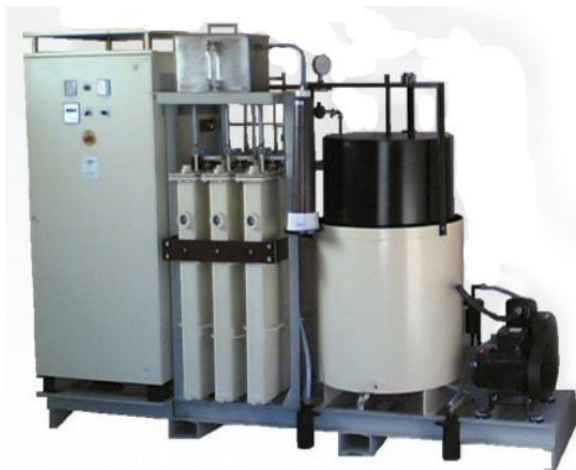
Рис. 9. Генератор водорода с накопителями
