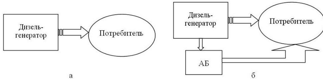
Рис. 1. Основные типы традиционных автономных энергоустановок
