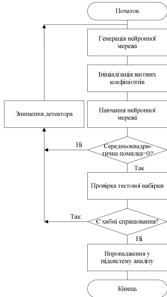
Рис. 2. Схema алгоритму функціонування підсистеми створення, навчання і відбору детекторів
