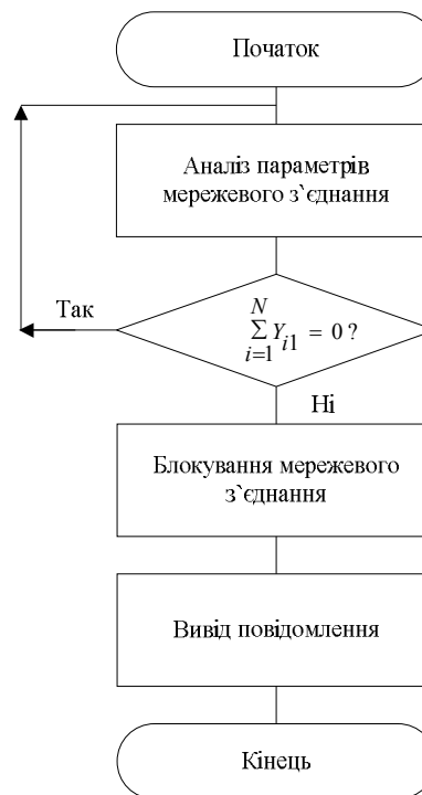
Рис. 4. Схема алгоритму функціонування підсистеми аналізу мережевого трафіку і виявлення мережевих атак
