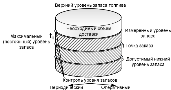
Рис. 3. Схема определения максимального уровня запасов нефтепродуктов
