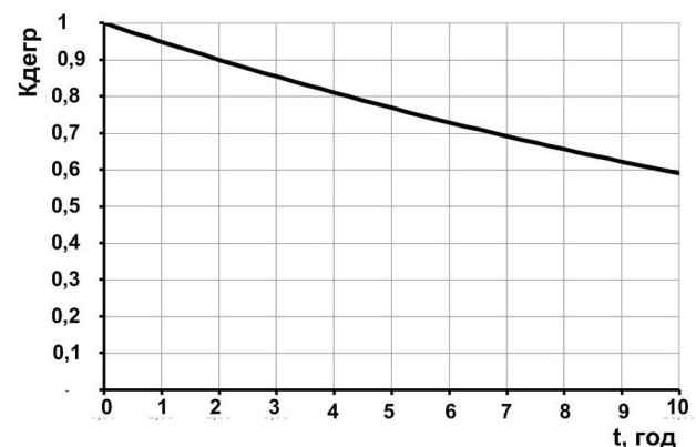
Рис. 4. Коэффициент деградации мощности БФ при длительной эксплуатации, выраженный в процентах
