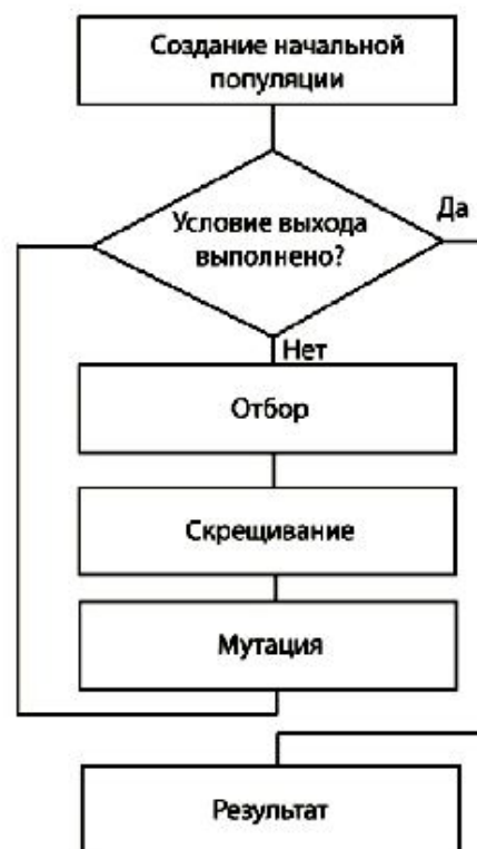
Рис. 3. Схема работы генетического алгоритма
