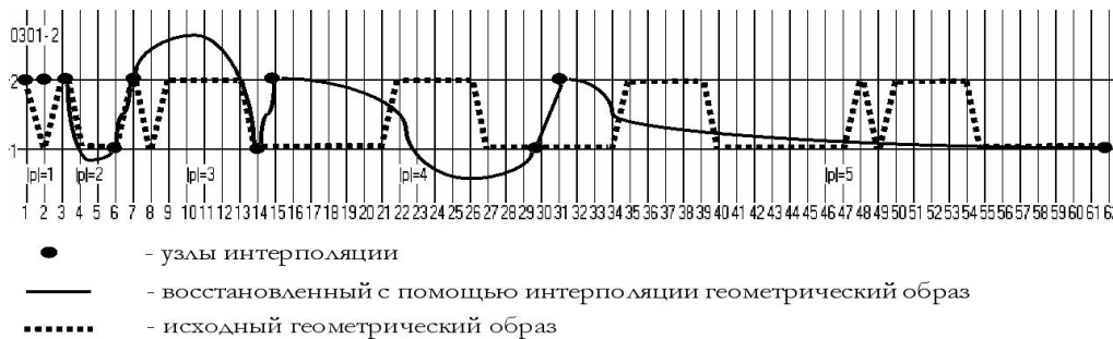
Рис. 3. Пример сравнения восстановленного с помощью метода интерполяции Ньютона и исходного геометрических образов (для 1 «пина» и |X|=2)
