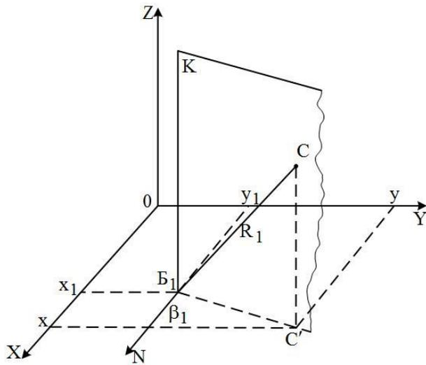
Рис. 1. Вариант измерения азимута пространственной точки с помощью одного пассивного измерителя направленного действия
