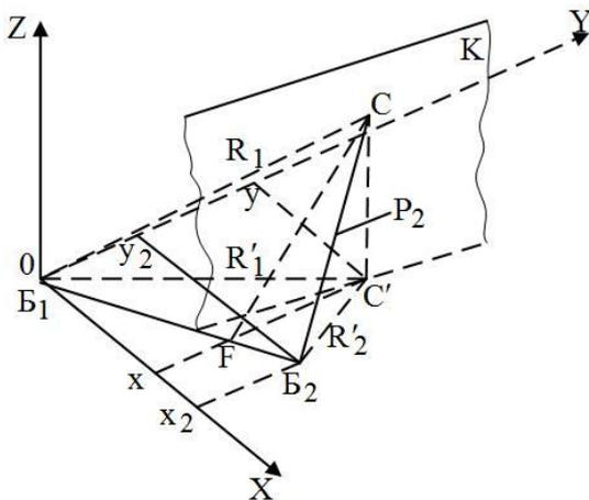
Рис. 3. Пояснение получения цилиндрической поверхности относительно двух измерителей
