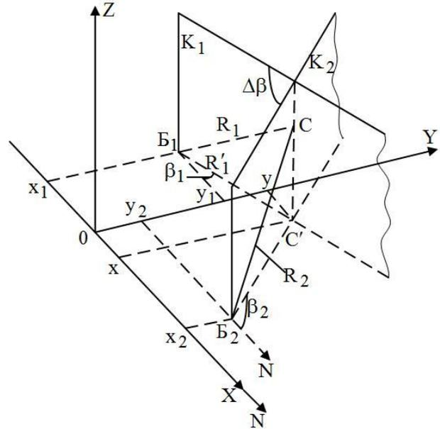
Рис. 2. Вариант получения цилиндрической поверхности путем измерения азимутов точки относительно двух пассивных измерителей направленного действия
