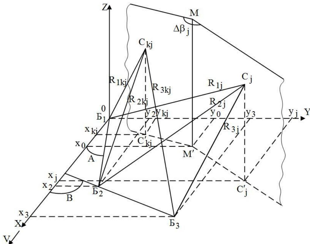
Рис. 4. Две плоскости, характеризуемые соответственно параметрами  $\lambda_j$  и  $\lambda_{kj}$ , которые относятся к пучку плоскостей с центральной линией  $MM'$
