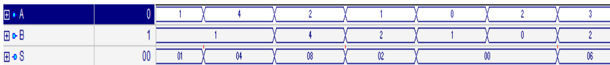
Рис. 3. Часова діаграма роботи оптимізованого матричного ПМ з горизонтальним переносом
