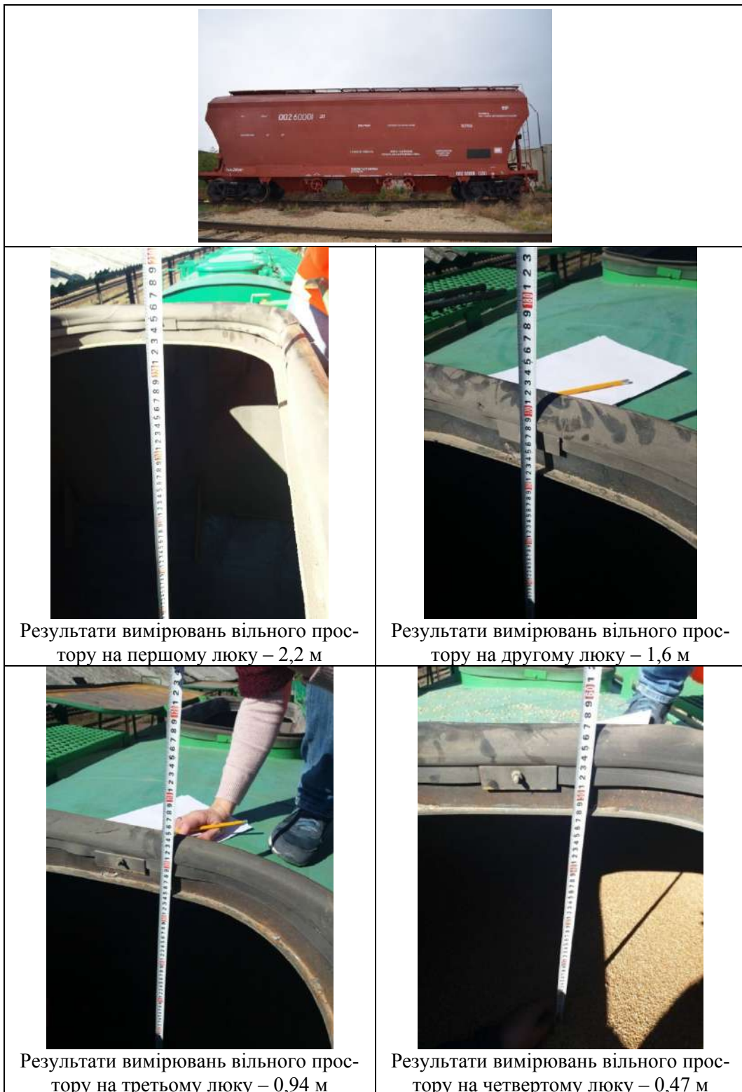
Рисунок 3 – Результати перевірки розміщення вантажу в зерновозі моделі 19-6869
