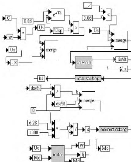
Рисунок 4 – Аналоговая модель работы силовой головки
