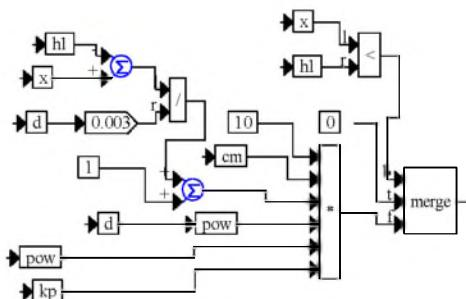
Рисунок 8 – Расчет момента сопротивления  $Mc$  - блок “moment cutting”
