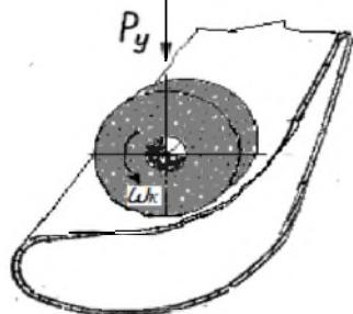
Рисунок 1 – Шлифование по упругой схеме
