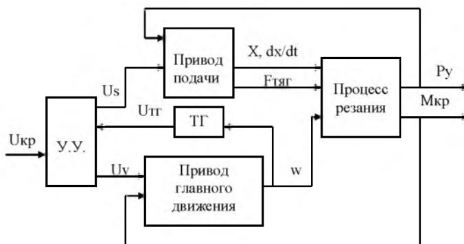
Рисунок 3 – Функциональная схема управления динамической системой силовой головки
