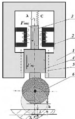
Рисунок 2 – Схема динамической системы силовой головки
