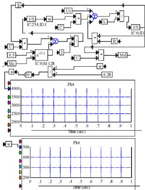
Рисунок 7 – Блок-схема аналоговой модели двигателя вращения
