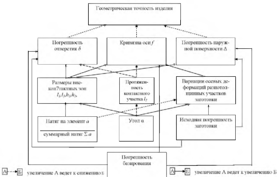
Рисунок 5 – Граф влияния технологических параметров, погрешности базирования, исходной погрешности заготовки на геометрическую точность изделия
