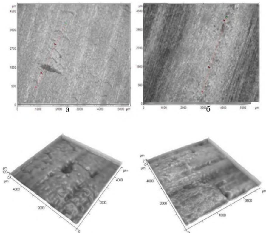
Рисунок 2 – Макроструктура поверхности до и после
