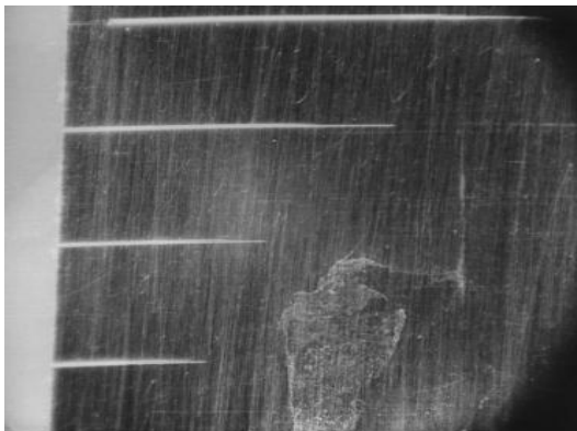
Рисунок 2 – Микрофотография риски-царапины на поверхности сплава «ВолКар»; Условия работы: зерно АС6 250/200; V = 25 м/с
