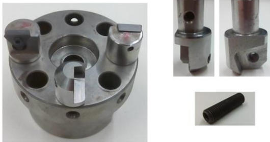
Рисунок 1 – Торцева касетна фреза (D=80 мм), касети до неї і затискний гвинт
