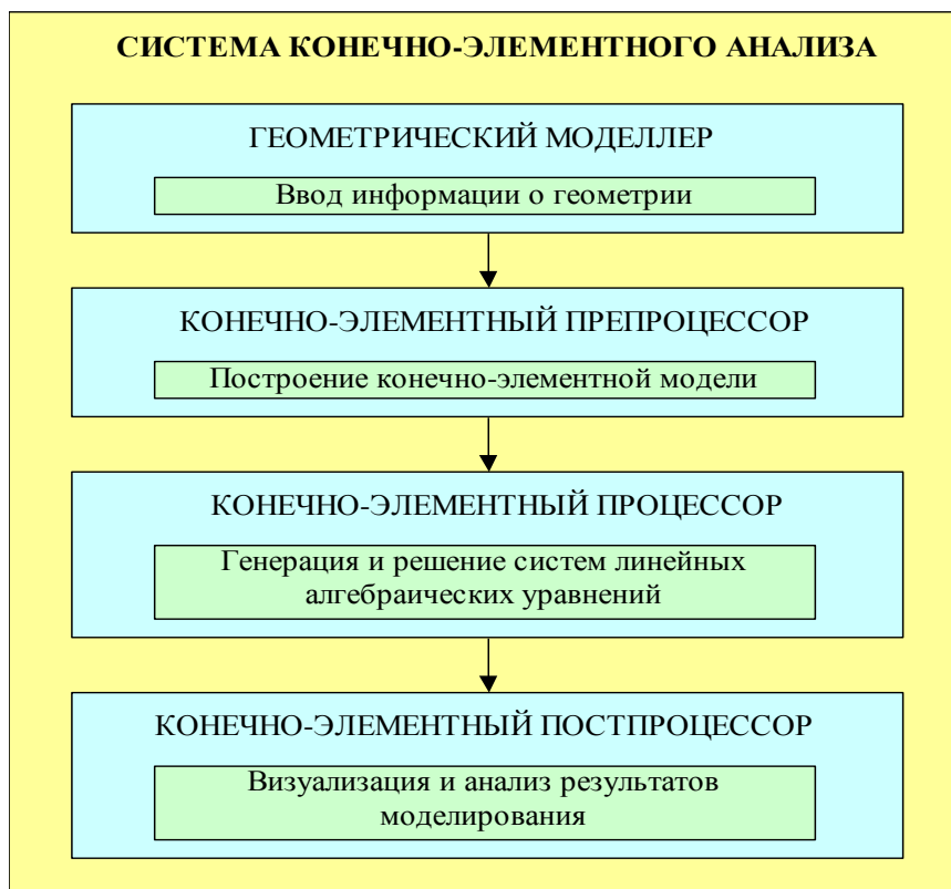
Рисунок 1 – Обобщенная структурная схема системы конечно-элементного анализа
