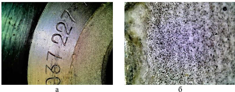
Рисунок 3 – Микроскопическая визуализация корундового покрытия на поверхности алюминиевого сплава (АК6) корпуса алмазного шлифовального круга при увеличениях (USB-микроскоп Supereyes B008): x4 (а, видна часть заводской маркировки инструмента); x100 (б, просматриваются выходы пористости на поверхность покрытия).
