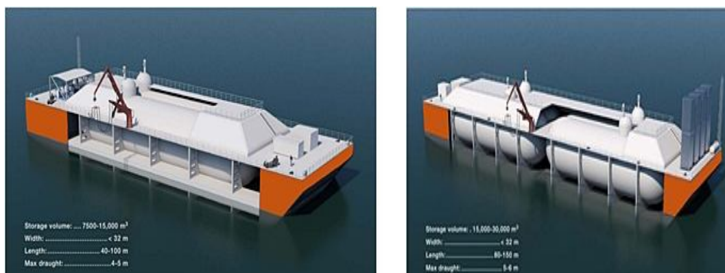
Рис. 6. Види FSRB (7 500-15 000 м 3 та 15 000-30 000 м 3 )
