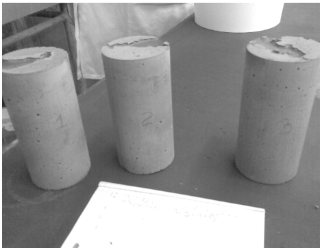
Рис. 3. Образцы легких бетонов для испытания на предел прочности при сжатии
