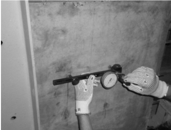
Рис. 2. Розміщення випробувальних плит на стелажах (а) і вимірювання деформацій усадки та повзучості компаратором (б)
