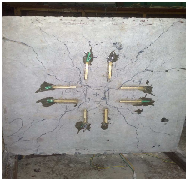
Рис. 4 Схема руйнування стиснутої зони
