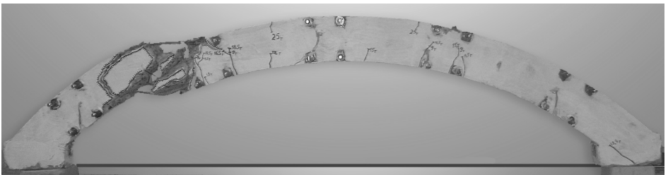
Рис. 4. Характер руйнування арки 1А-1
