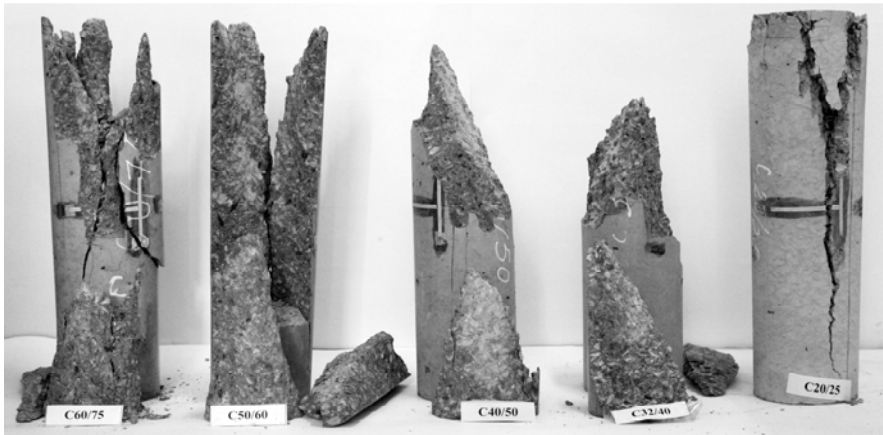
Рис. 2. Характер руйнування дослідних зразків бетонів
