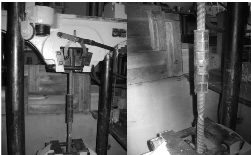
Рис. 6. Характер руйнування зразка з'єднання з гідравлічною обтискною муфтою
