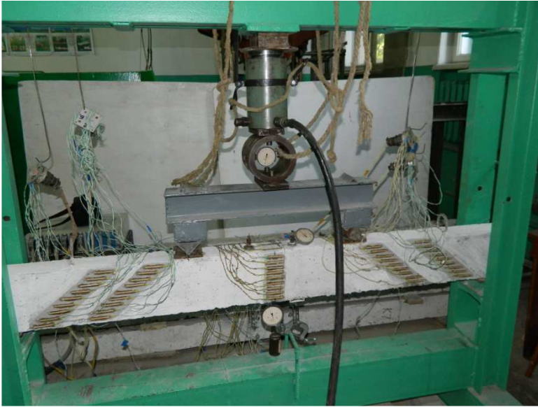
Рис.2. Вигляд дослідної установки та розташування приладів на балці випробуваній до підсилення
