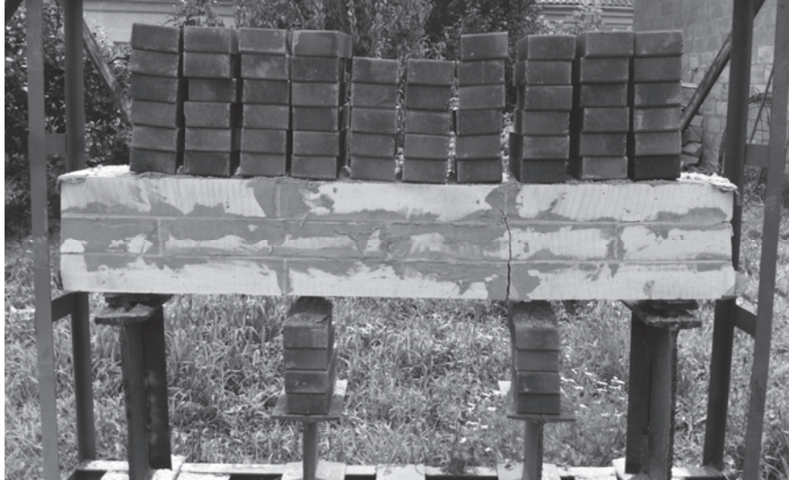
Рис. 5. Общий вид образования нормальной трещины
