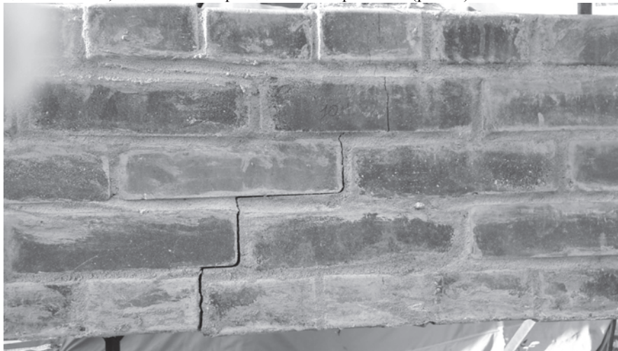
Рис. 8. образование нормальной трещины (образец Б-...)
