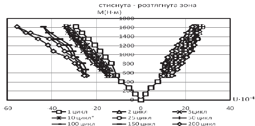
Рис.3 Діаграма деформування дощатоклеєної балки БДК-6 за дії повторних навантажень
