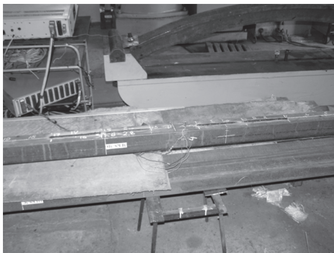
Рис. 3. Правка образцов с остаточным прогибом с помощью наплавки холостых валиков сварных швов
