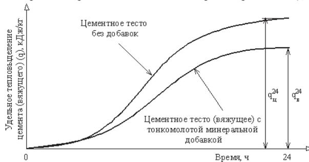
Рис 4. Кинетика изменения удельного тепловыделения цемента и вяжущего
