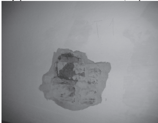
Рис. 5. Випробовування цегли та відбір зразків розчину з кладки
