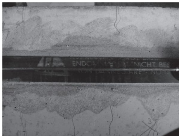
Рис.4 Характер поширення тріщин біля композитної арматури
