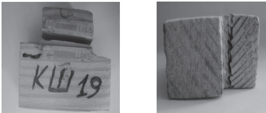
Рис. 4. Руйнування зразка КШ 19(0,2-0,8)
