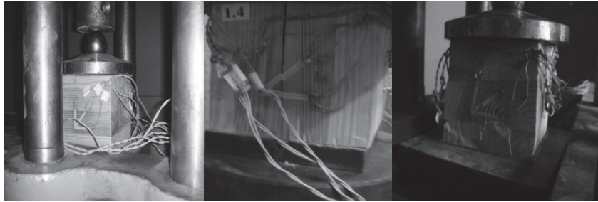
Рис.2 Разрушение образцов при испытании проф. Фурсовым В.В. и аспирантом Бидаковым А.Н.
