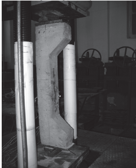
Рис. 1 – Загальний вигляд установки ПГ - 125 для випробування колон.
