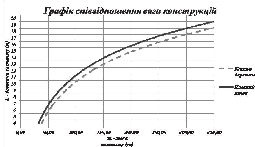
Рис. 5 Вага елементів з клеєного шпону та клеєної деревини в залежності від прольоту
