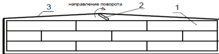
Рис. 3. Схема включения замкнутой обоймы с помощью поворота плоского рычага. 1 – легкобетонные блоки; 2 – плоский рычаг; 3 – обойма
